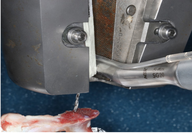
Resim 2. İmplantların standart yerleşimi için kullanılan Instron cihazı.
